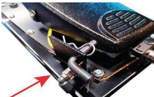
Fig. 29 : Serrure à goupille avec goupille de sécurité
